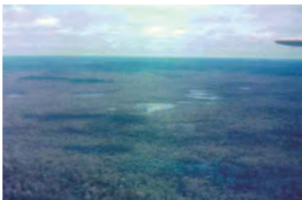
Figura 3. Parte do reservatório de Balbina durante o enchimento, com o nível da água na cota de 47 m acima do nível do mar (3 m abaixo do nível cheio do reservatório). Um terço do reservatório tem menos que 4 m de profundidade.
