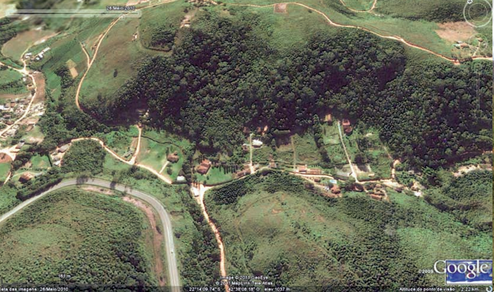
FIGURA 64: BR 492 em Nova Friburgo. Vista de região com parcelamento do solo com construções na meia encosta de morro com inclinação superior a 45° e com topo do morro desmatado. Observa-se construções também na margem dos cursos d'água. (Imagem Google Earth - 26.05.2010)
