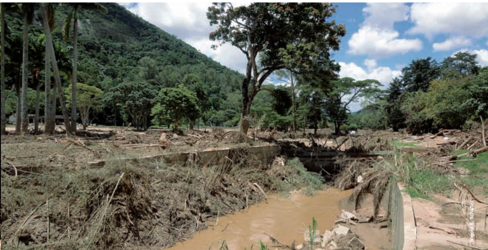
FIGURA 50: Vale do Cuiabá em Petrópolis. Na foto observa-se uma ponte estreita obstruída por detritos e canalização do rio a jusante da ponte. Destaca-se que nos casos de grandes enxurradas as canalizações, feitas para retificar o curso d'água e acelerar seu escoamento, acabam potencializando os efeitos das enchentes. (Foto - 25.01.2011)
