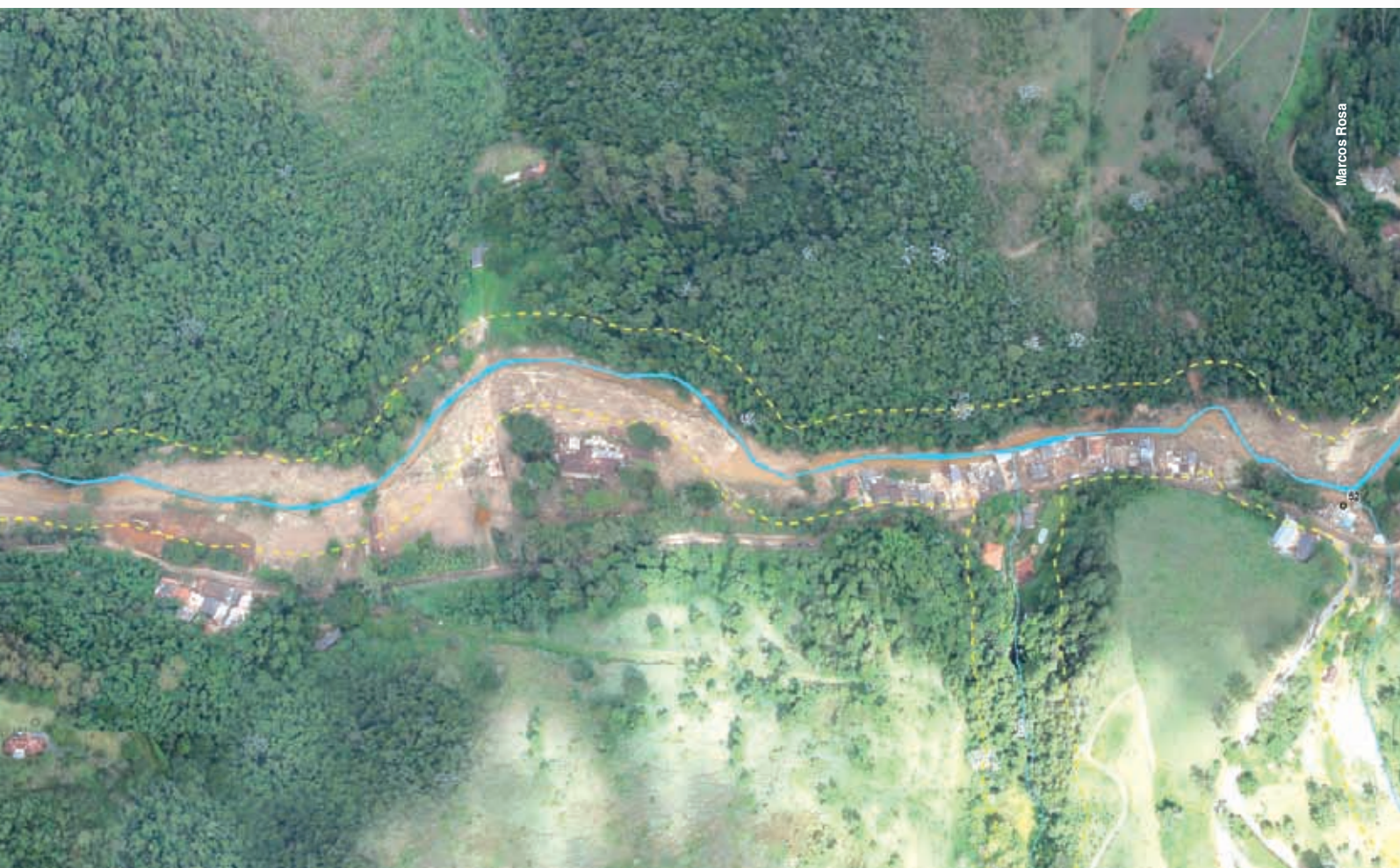
FIGURA 52: Vale do Cuiabá em Petrópolis, mesma área da figura 51. Podem ser observados os efeitos da inundação sobre as habitações localizadas na margem do rio. A maioria das edificações afetadas encontravam-se total ou parcialmente dentro da faixa de APP de 30 metros. Nota-se também que na margem oposta, no trecho onde a vegetação estava preservada os efeitos da inundação são menores, e, o que é mais importante, não houve prejuízos socioeconômicos e perda de vidas. (Foto aérea - 26.01.2011)
