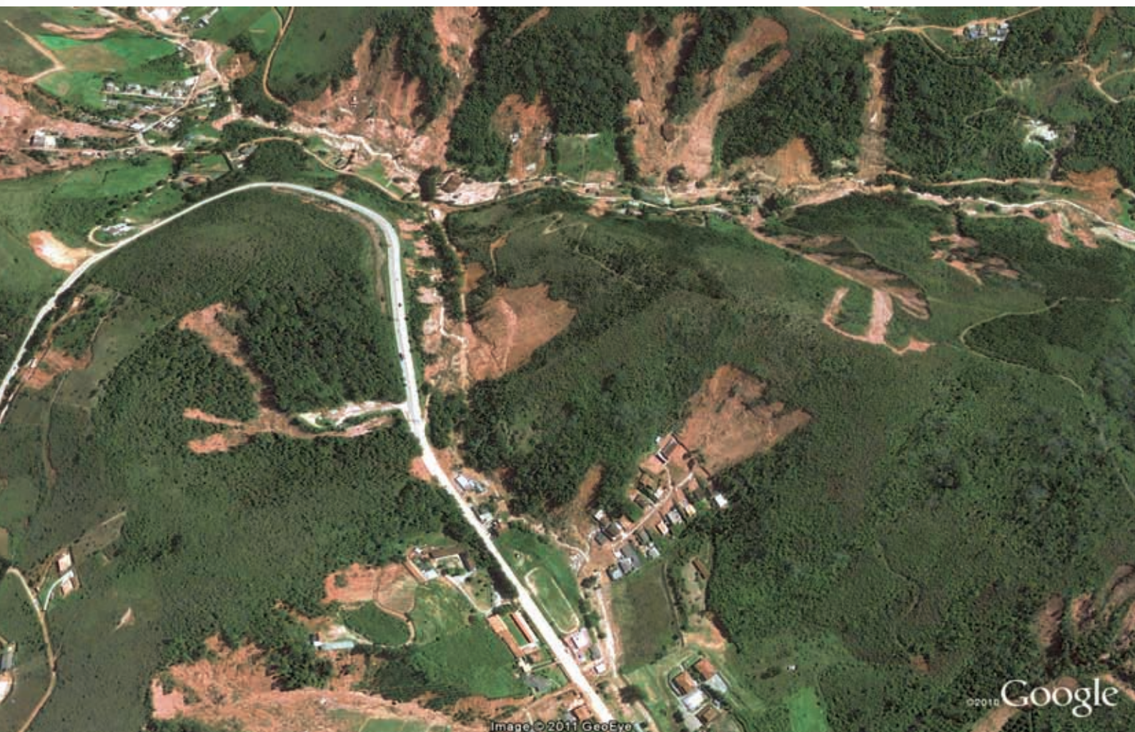
FIGURA 77: Loteamento em encosta às margens da BR 492 em Nova Friburgo, mesma área da figura 76. O loteamento foi severamente atingido por deslizamento e percebe-se a relação com a intervenção humana (construção de estradas na encosta e topo de morro desmatado com vegetação remanescente recentemente atingida por queimada). (Imagem Google Earth - 19.01.2011)
