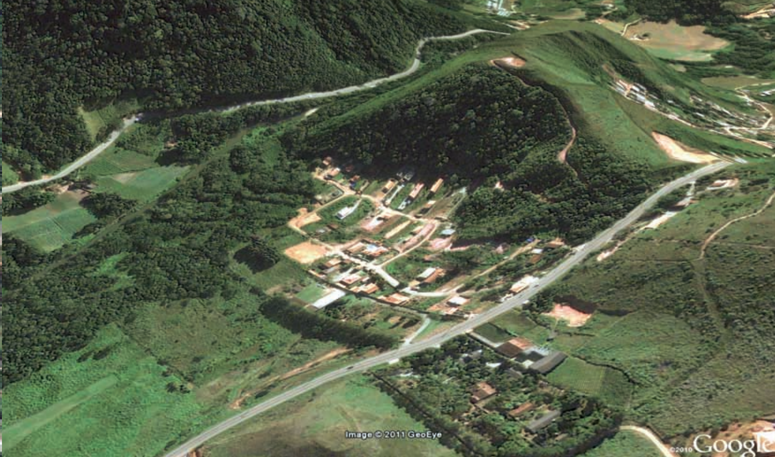
FIGURA 74: Condomínio do Lago, BR 492 em Nova Friburgo. Observa-se que o condomínio foi instalado numa área plana com habitações construídas junto a base de morro com topo desmatado e estrada cortando seu vértice. (Imagem Google Earth - 25.05.2010)
