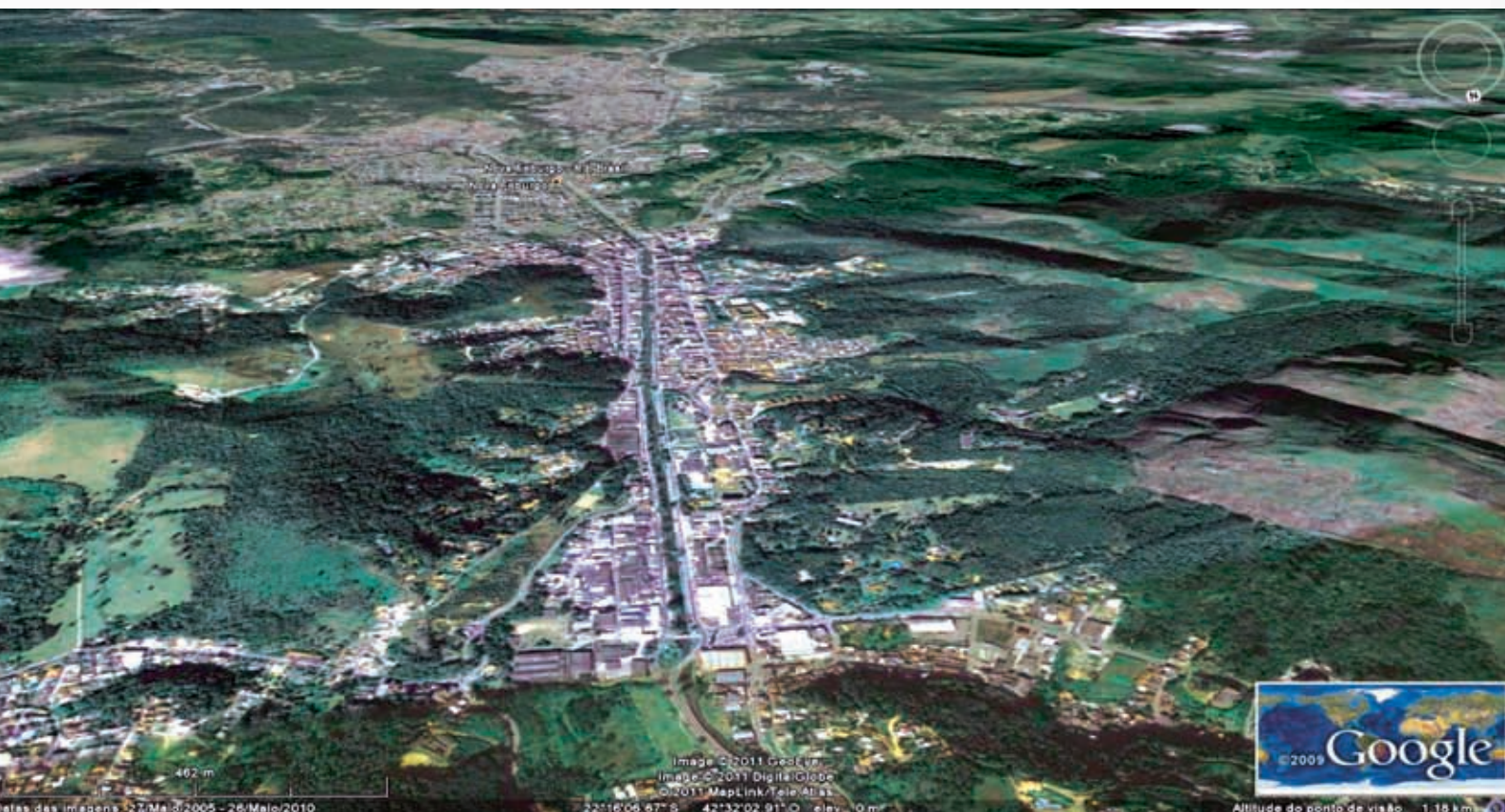
FIGURA 81: Cidade de Nova Friburgo. Pode-se observar a canalização do rio em toda a extensão da cidade. Mesmo rios canalizados exigem a manutenção das faixas marginais de APP. No caso em tela 30 metros em cada margem não deveriam estar ocupados. (Imagem Google Earth - 2010)
