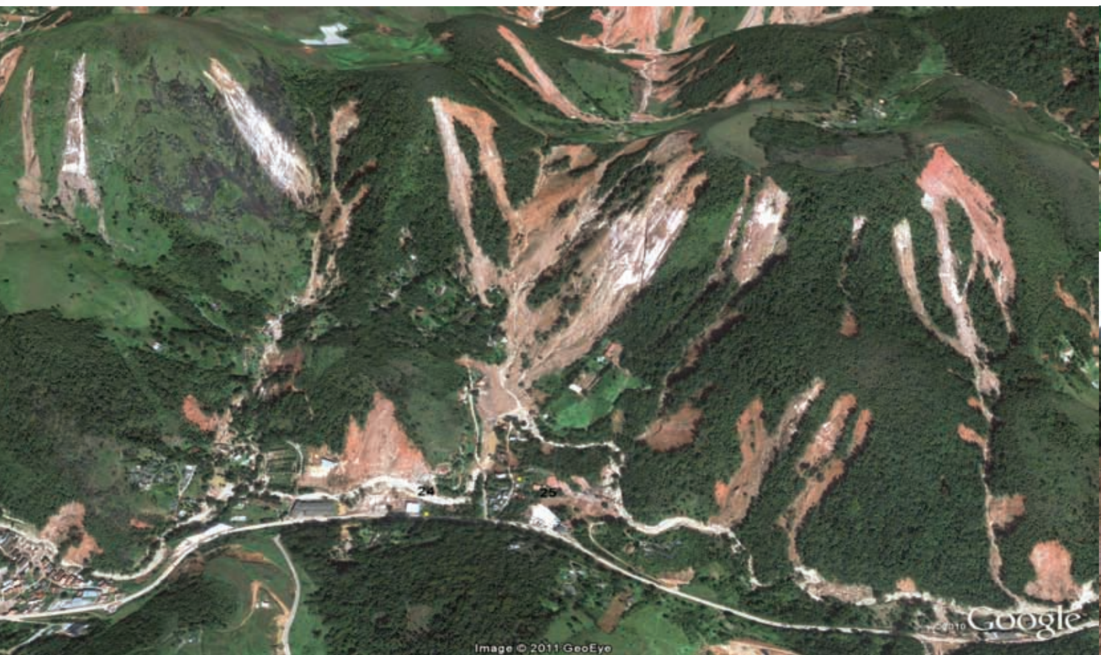
FIGURA 69: Região do Córrego Dantas em Nova Friburgo, localidade denominada Sítio dos Esquilos. É possível observar que os deslizamentos ocorreram em áreas consideradas de preservação permanente (APP de topo de morro, de encosta e de margem de rio). (Imagem Google Earth - 19.01.2011)
