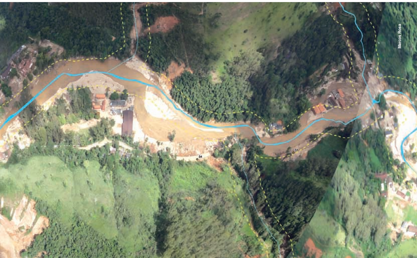
FIGURA 56: Vale do Cuiabá em Petrópolis, mesma área da figura 55. Observa-se que a área mais severamente afetada abrange a faixa de APP de 30 metros em cada lado da margem dos cursos d'água, área delimitada por linha pontilhada amarela. (Foto aérea - 26.01.2011)
