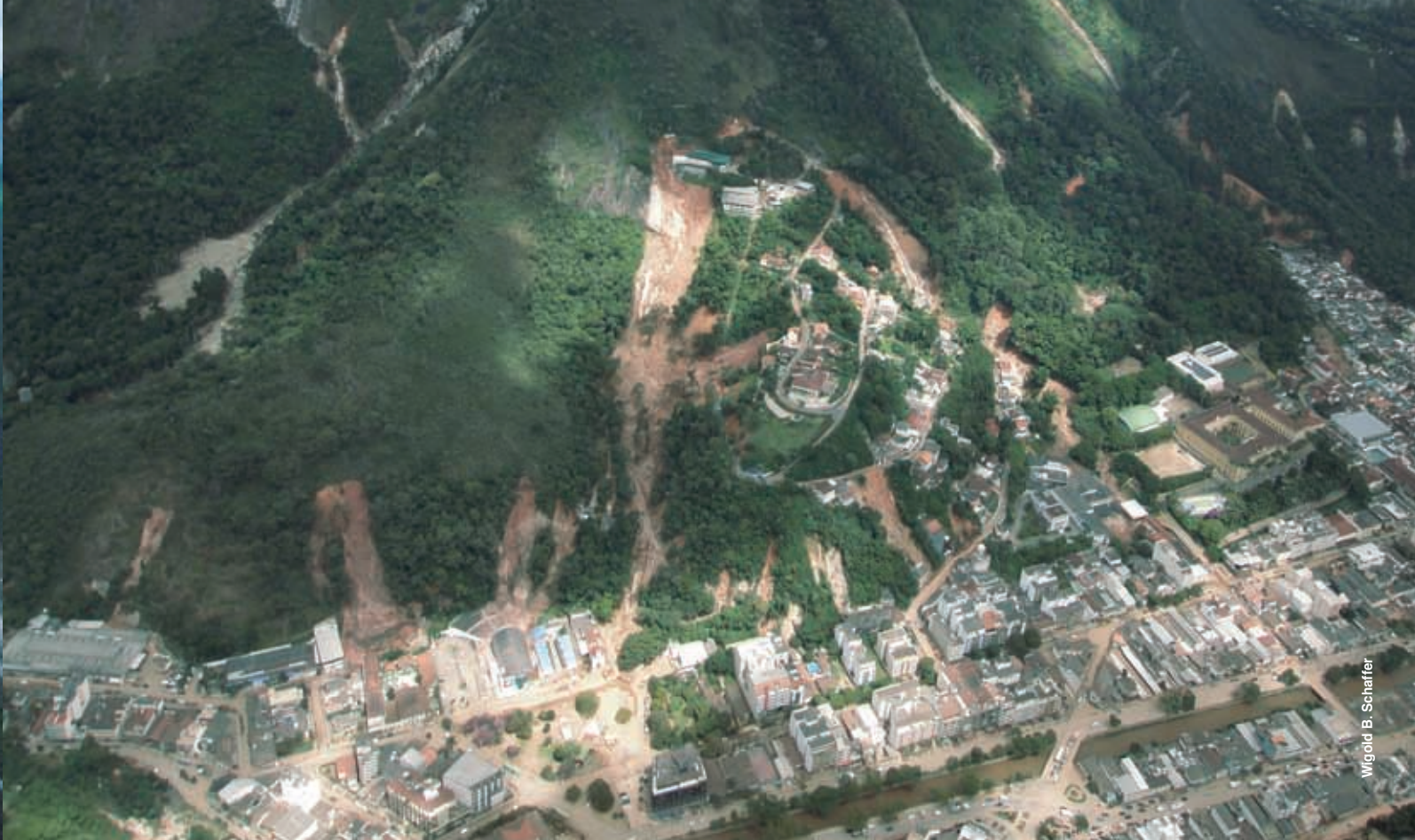
FIGURA 9: A foto mostra que não apenas as ocupações situadas nas encostas, mas também aquelas situadas ao sopé de morros ou montanhas com encostas de alta declividade correm o risco de serem atingidas pelos deslizamentos e rolamento de rochas. (Foto aérea - 26.01.2011)
