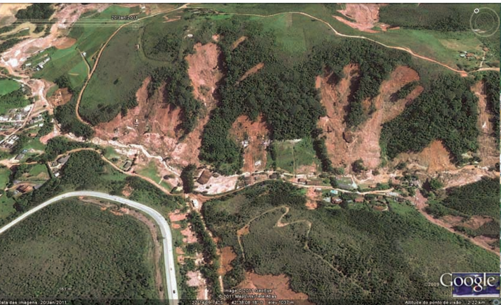
FIGURA 65: BR 492 em Nova Friburgo, mesma região da figura 64, mostrando deslizamentos e corrida de lama e rochas que atingiram casas na encosta e na margem dos cursos d'água. Nota-se os topos de morros desmatados e intervenções diversas nas encostas: construção de estradas e edificações. Nota-se também que as casas e outras edificações nas margens dos cursos d'água foram severamente afetadas. (Imagem Google Earth - 20.01.2011)
