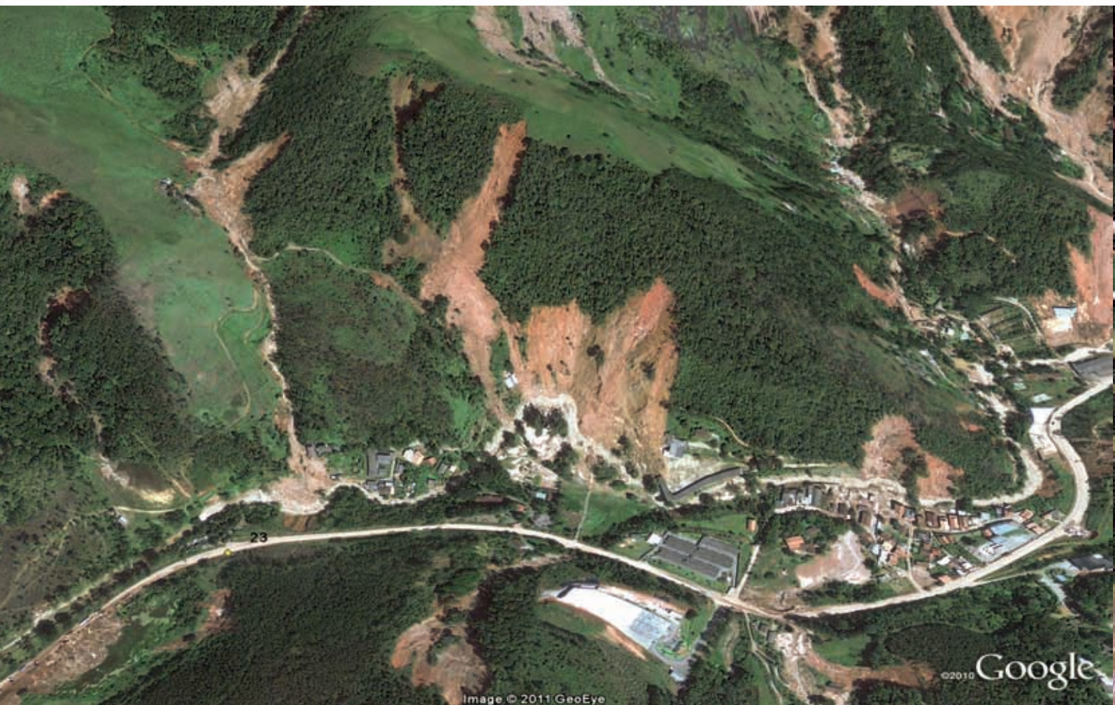
FIGURA 73: Região do Córrego Dantas às margens da rodovia BR 492 em Nova Friburgo, mesma região da figura 72. As edificações nas margens dos cursos d'água (principal e afluentes) foram severamente afetadas. Observa-se também que os deslizamentos estão associados às áreas de topos de morros desmatados e com a construção de estradas no sopé do morro e na meia encosta, em área com declividade acima de 45°. (Imagem Google Earth - 19.01.2011)
