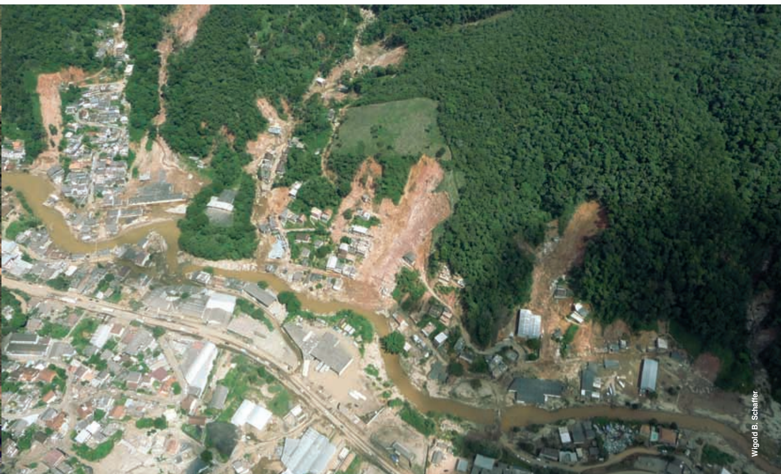
FIGURA 67: BR 492 em Nova Friburgo, trecho do Córrego Dantas. Observa-se que as edificações nas margens dos cursos d'água (principal e afluentes) foram severamente afetadas. Observa-se também as construções de estradas e edificações no sopé do morro e na meia encosta, em área com declividade acima de 45°. É possível verificar ainda que na área coberta por floresta bem conservada (lado direito no alto), onde não há intervenção humana próxima, não ocorreram deslizamentos. (Foto aérea - 26.01.2011)
